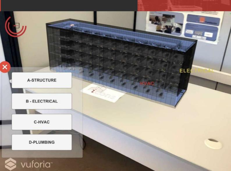
Wenn das System diese Markierung erkennt, zeigt es ein schwebendes virtuelles Modell des Gebäudes an. Während das Mobilgerät auf die Markierung gerichtet ist, können die Details des Gebäudes und die verschiedenen BIM-Informationen betrachtet werden, indem man einfach das AR-Gebäude umkreist.
